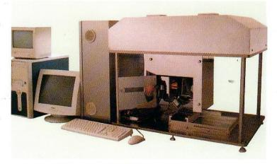
本光はんだ付け装置は、キセノンランプの光の熱を利用した非接触タイプのはんだ付け装置です。ガルバノ機構により高速走査で、セルフアライメントが可能です。また、PID (Proportion Integration Differential)によるランプ光量制御を用いることにより様々な加熱温度に対応可能で、あらゆるはんだ付け不良を解消します。
