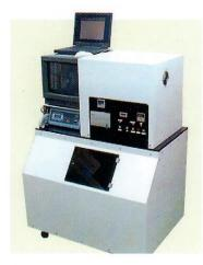
本露光装置は、Texas Instruments社の0.7XGA DMDを用いたCAD図をそのまま転送するマスクレス露光装置です。 通常のアライナとしての機能のほか、中間調画像をデータとして与えることによりハーフトーン露光が可能であり、MEMS (MicroElectrical Mechanical Systems)の試作をはじめ、高周波用ストリップ線路・プリント基板の試作・露光データを毎回変更する必要があるタイトラーとしての使用など、幅広い応用が可能です。
