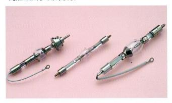
超高圧水銀・水銀キセノン小型ショートアークランプは、365nm以下の短波長も有効に活用できる光源です。小型ショートアークランプは、超長寿命を実現するために特殊陰極を採用した光源で、半導体露光に主に使用されます。
