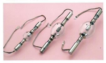
超高圧水銀・水銀キセノン大型ショートアークランプは、365nm~436nmの紫外域の 波長を有効に放射するために開発された光源です。長寿命で高安定の高輝度 光源は微細技術が必要となるPCB・LCD・PDP業界でのメイン露光に使用されます。
